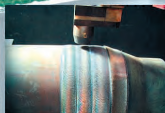
3. Auftragsschweissung Hard Banding
