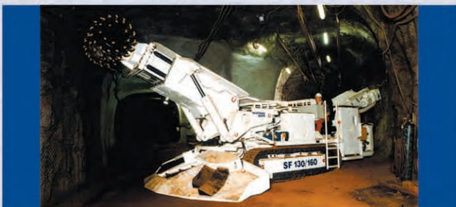
Teilschnitt Maschine • Road Heading Machine
