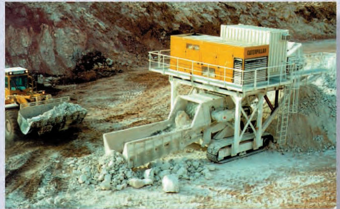
Walzenbrecher • Roll Crusher (Feeder Breaker)
